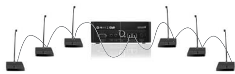
デイジーチェーン方式：1ライン50台まで、2ライン合計100台まで
