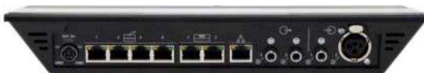
背面には、後述の電源・各種通信ポート・アナログ AUX 入出力を実装しています。
