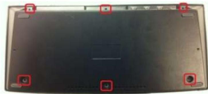
3. 内部配線に十分に注意して、ユニットのフロントパネルを取り外します。
