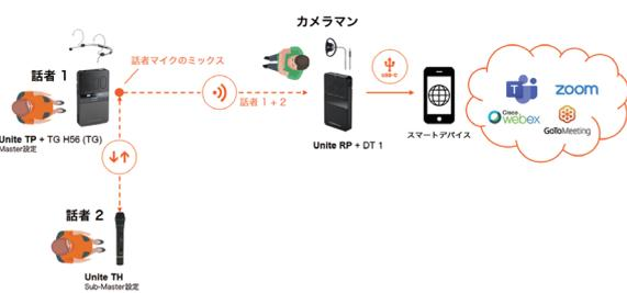
話者1と2のワイヤレスマイクの音声をカメラマンの持つ受信機で受信し、そのUSBインターフェイスで配信元のスマートフォンに音声取り込み。カメラマンは送信音声を受信機に接続したイヤホンで同時にモニタリングすることも可能
