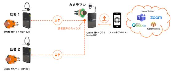
一方的な配信ではなく遠隔地とのやり取りが必要な場合、ヘッドセットマイクを装着すれば、遠隔地音声を話者が聞き、話者の音声を遠隔地に送る双方向通信も実現可能
