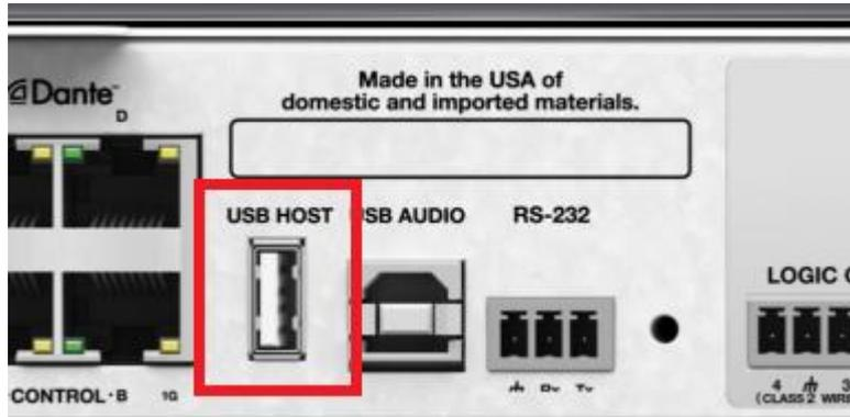
USB HOST ポートに USB メモリを接続すると、最大 8ch のマルチトラック録音と、最大 8ch のマルチトラック再生機能を使用することができます。
