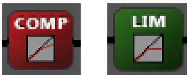
Stewart Audio DSP シリーズは一般的なコンプレッサー及びリミッターを各チャンネルに搭載しています。
