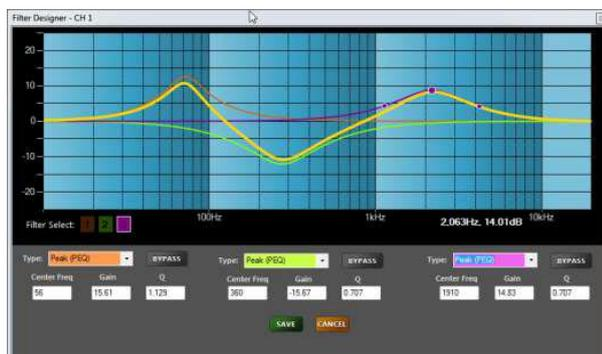
フィルタータイプを選択すると周波数とゲイン、スロープを入力もしくは選択するボックスが表示されます。
