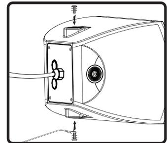
8. 安全ケーブルを取り付ける場所を選択し、その側面からU字型ブラケットのネジを外します。安全ケーブルをクランプリングネジに取り付けて、緩めに取り付けます。
