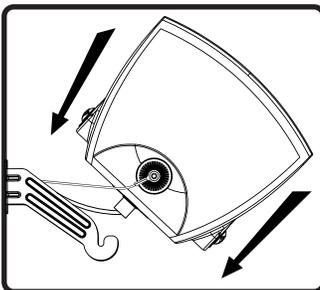
9. スピーカーを45° 傾けて (グリルアップ)、スライドさせてブラケットに取り付けます。
