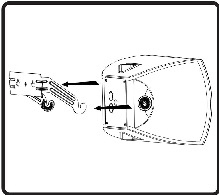
1. このユニットの耐候性 (WX) を最高にするには、スピーカーと一緒に箱に入ってきたブラケットを見つけて捨てる必要があります。WXユニットには、代わりに使用される独立したステンレス鋼製の取り付けブラケットが付属しています。
