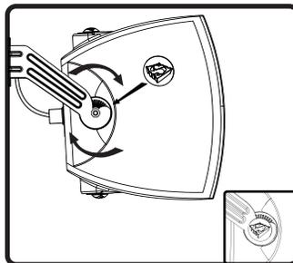
10. スピーカーを向け、U字型ブラケットのネジを締めます。締め付けたら、ネジキャップをネジの上に配置します。
