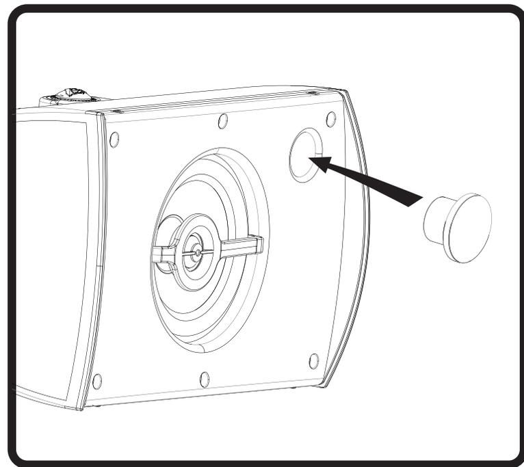
2. このユニットの耐候性を極限 (WX) にするには、箱に入っているポートプラグを取り付ける必要があります。縁の周りにあるネジを外してグリルを取り外します。グリルは簡単に外れるはずですが、ポートプラグをバッグの穴に押し込み、グリルを再度取り付けます。
