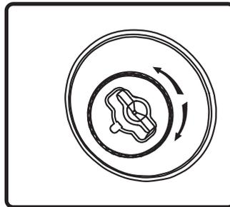
6. スピーカーの背面にあるロータリースイッチを希望の設定に回してタップ位置を選択します。スイッチは、70.7Vモードの最大タップ設定 (SM52-EZの場合は32W [-WX]、SM-82-EZ-IIの場合は64W [-WX]) にプリセットされています。
