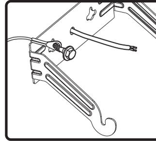
3. クランプスロットを上に向けてU字型ブラケットを取り付けます。ブラケットとワイヤーをしっかりと固定します。(ユーザーがケーブルを供給する必要があります)。注: ワイヤーは、キャビネットのU字型ブラケット固定ねじに取り付けられます。
