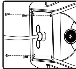
7. バックプレートを取り付け、付属の留め具で固定します。
