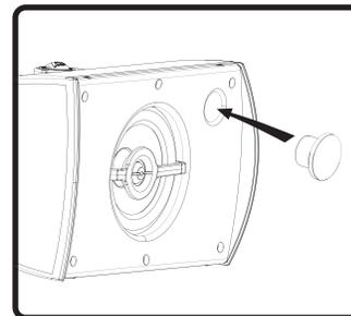
内部の部品を湿気やその他の潜在的に腐食性の元素から保護するために、付属のポートプラグを使用してエンクロージャを密閉します。保護を強化するために、ポートプラグの端にRTVシリコーンを使用してください。
