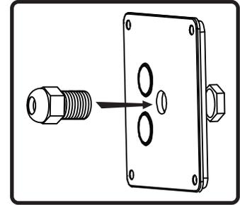
4. EN54-24規制に従って設置される場合、または防水が必要な場合は、付属のケーブルクランプをバックプレートに取り付けてください。不要な場合は、この手順を飛ばしてください。
