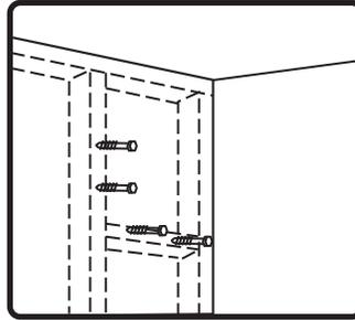
2. スピーカーを確実に保持するのに十分な強度のあるしっかりした取り付け面を選択してください。スピーカーは、同じU字型ブラケットを使用して垂直または水平のどちらの位置にも取り付けることができます。
