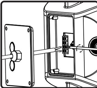
5. 信号線をストレインリリーフブッシングを通してから、セラミック端子板に接続します。デジチェーン接続用に2つの+ (プラス) および2つの- (マイナス) コネクタが用意されています。
