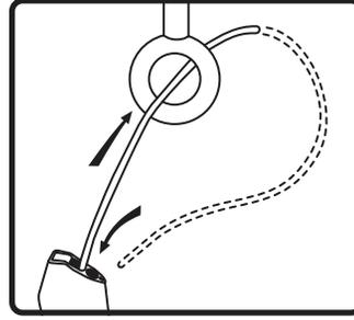
3. 吊りケーブルと安全ワイヤーを図のような構造に固定して取り付けます。
