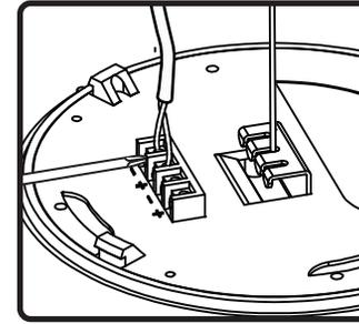
7. 信号線を(+)と(-)の入力に接続します。リンクには追加の(+)と(-)を使用します。
