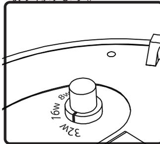
10. 希望のタップ位置を選択してください。スイッチは最大70.7V (100V) モードにプリセットされています。
