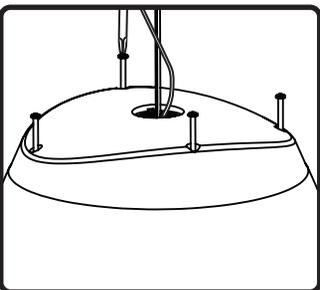
12. カバープレートを固定する4本のネジをすべて締めます。
