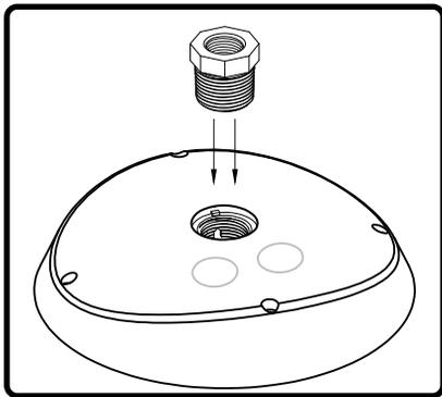
1. 3/4" - 3/8" NPTアダプタをスピーカーのトッププレートの穴にはめ込みます。
