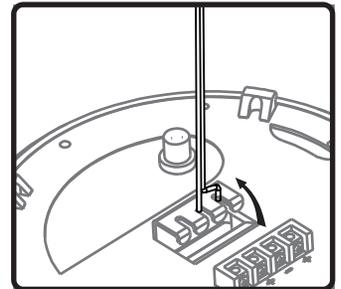
7b. 中央のスロットと揃ったら、ワイヤーをスロットに引き上げて固定します。手順7aと7bを繰り返して安全ワイヤーをサイドスロットの1つに差し込みます。
