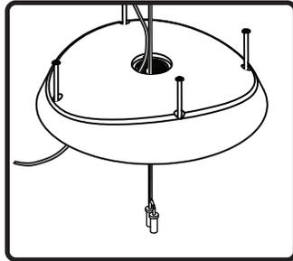
6. カバープレート吊りケーブルと安全ワイヤーの上にスライドさせ、信号線を中央の穴に通します。
