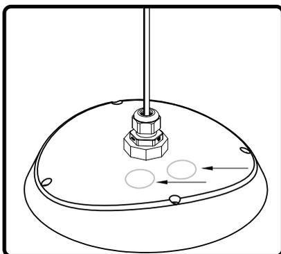
4. 付属のコンジットロックアウトに信号線を通します。
