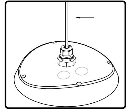
3. 取り付け手順に記載されているように、3/8" NPTワイヤーグランドにスピーカーセキュリティケーブルを通し、スピーカーの背面に取り付けます。
