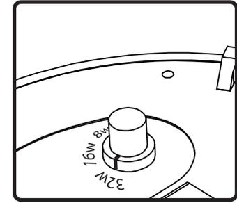
8. 希望のタップ位置を選択してください。スイッチは最大70.7V (100V) モードにプリセットされています。
