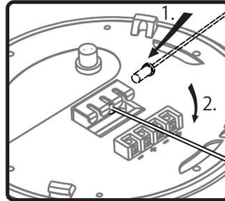
7a. (1)マウントブラケットの側面から挿入し、(2)ぶら下げブラケットの中央のスロットに合うように回転させて、ぶら下げワイヤーを取り付けます。
