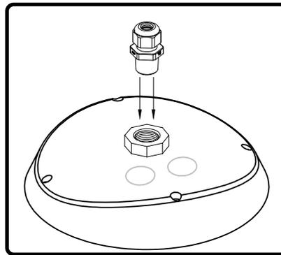
2. 3/8" NPTワイヤーグランドを3/4"から3/8" NPTアダプターに通します。水密性を確保するためにしっかりと締めてください。
