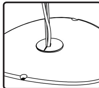
13. ワイヤー上にスリットをスライドさせて雨水防止ゴムを取り付け、カバープレートの穴にぴったりと押し込みます。
