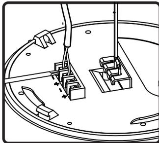
9. 信号線を(+)と(-)の入力に接続します。リンクには追加の(+)と(-)を使用します。
