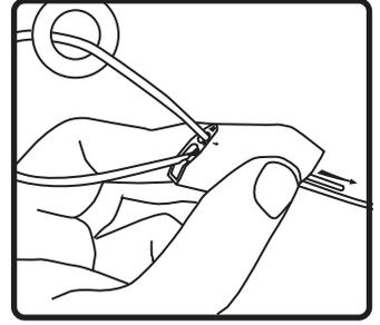
4. 図のように、ケーブルの端をSpeedClamp™に通します。
