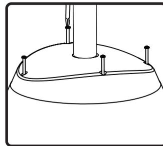
10. スピーカーをカバープレートに固定する4本のネジをすべて締めます。
