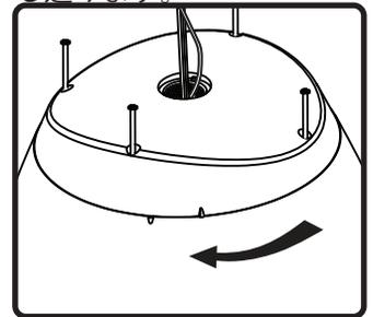
11. カバープレートをスピーカーの上に置き、位置合わせが合うまで時計回りに回転させます。
