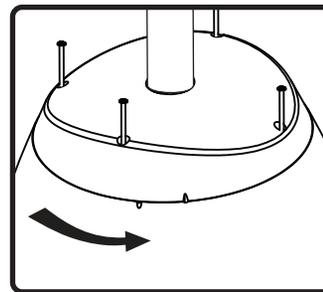
9. スピーカーをカバープレートに合わせ、回転させて所定の位置に固定します。固定されると、アライメントマークが合います。
