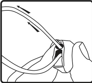
5. SpeedClamp™でスピーカーの吊り下げ高さを調整します。図のようにSpeedClamp™のボタンを押して緩め、調整します。
