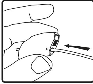
2. 図に示すように、SpeedClamp™に吊り下げケーブルまたは安全ワイヤーを通します。
