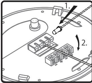
5. 最初に取り付けブラケットの側面に挿入して、安全ワイヤーを取り付けます。
