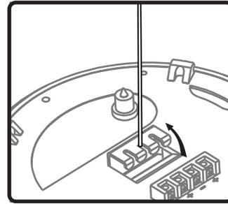
6. 安全ワイヤーを中央のスロットに合わせ、引き上げて固定します。
