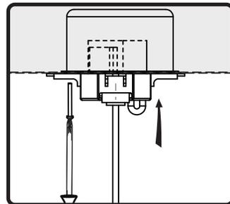
4. 付属の取り付けネジを使用して、取り付けプレートを骨組みかジャンクションボックス（別売）にねじ込みます。
