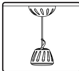
11. カバープレートを完全にねじ込んでスピーカーを固定します。
