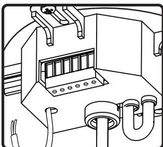
6. RS31-EZ-Tの配線：図のように、負(-)の信号線を「com」に、正(+)の信号線を目的の接点に接続します。
