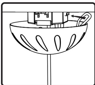
10. 余分な線をプレートの内側に隠すには、余分な線を時計回りに、カバープレートと天井との間の隙間に巻き付けます。
