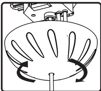
9. カバープレートをスピーカーに近づけ、カバープレートと取り付け面の間にスペースを残して、カバープレートをマウントプレートにねじ込み始めます。
