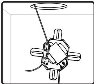
2. ワイヤ開口部を介して天井から取付プレートに信号線を通します。
