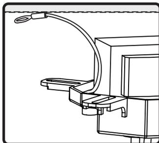
3. 必要に応じて、安全ひもを骨組みもしくはジャンクションボックスの固定場所に接続します。
