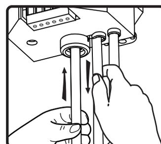
8. スピーカー線を調整してスピーカーの高さを設定します。吊り下げを短くするには、調整線を引きながら、スピーカーラインを中央の穴に通します。長くすると逆になります。
