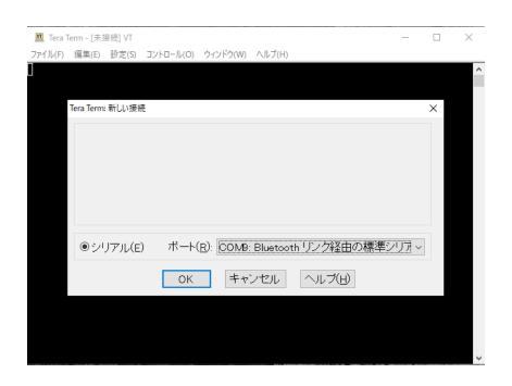
正常に接続されると、DD-BTN44 の Pair ボタン左に配置されている LED がオレンジ色に 点灯し、Tera Term ウィンドウに「 $^{-}$ 」プロンプトが表示されます。
