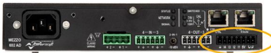
図 2 - Mezzo 602 AD の GPI 端子
