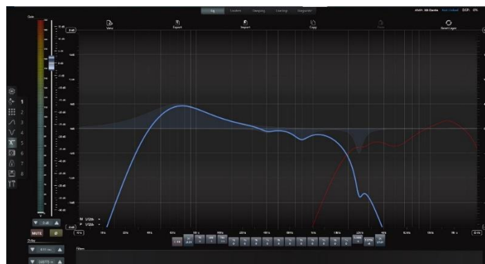
図 187 – チャンネル1(青線)とチャンネル2(赤線)の 2Way スピーカー設定
