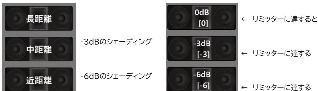
図 109- スピーカーのシェーディング調整例
