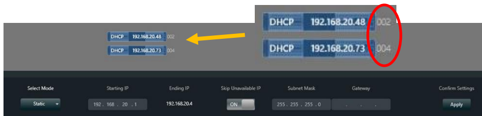
図 77 - static(静的設定)
