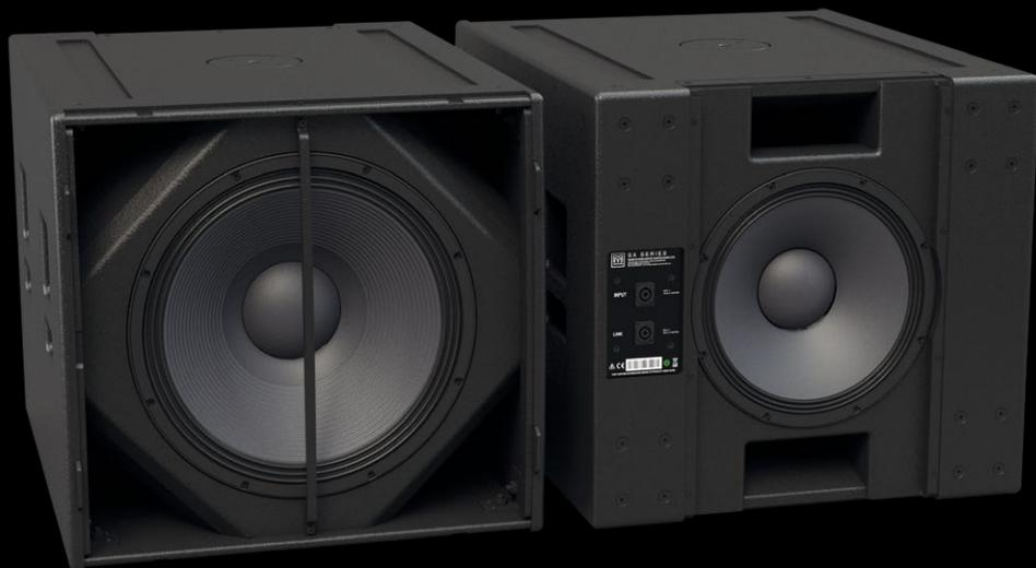
ツアー環境にも施設設置にも使用できるよう設計されたSXC118はコンパクトでハイパフォーマンスなカーディオイドサブウーファーです。18インチ(460mm)前面ドライバーと14インチ(356mm)後面ドライバーを特徴とし、別々のアンプチャンネルとDSPでそれぞれ独立して駆動します。各ドライバーはそれぞれ独立したバスレフポートを備えています。この配置が前面エネルギーを最大化し、サブウーファー後方の不要なエネルギーを減らすカーディオイドのパターンを生み出します。推奨されるiK42アンプはDSPパラメータで前面後面ドライバーの出力を最大化し、43Hzで21dBから75Hzで28dBもの後方減衰を可能にします。これによりステージ、ターンテーブル、壁への回り込みを避け、室内の残響エネルギーを減らすことができ、システムの低域レスポンスの精度と影響を大幅に改善します。
