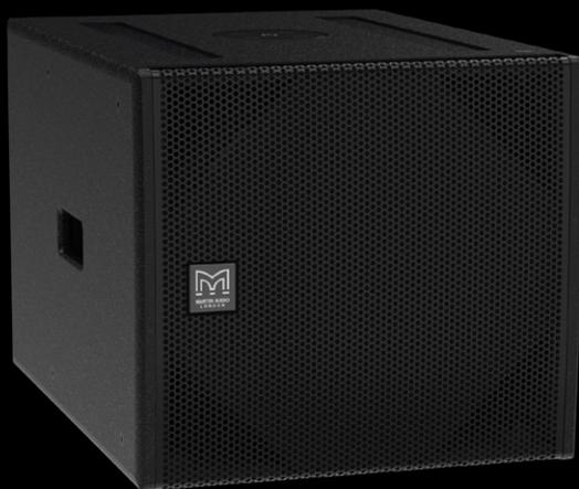
SX115はフレキシブルなサブウーファーで45Hz -100Hz (±3dB)の再生帯域を持ちます。3重構造の防水コーンを持つパワフルなロングエクスカーション15インチ(380mm)/4インチ(100mm)ボイスコイルを備えており、コンパクトなエンクロージャーから迫力ある低域を出力します。4つのリフレックスポートはその形状を調整したことで、高出力時の風切り音を抑制します。
