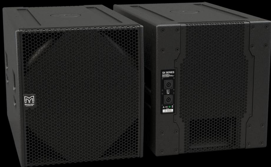
ツアー環境にも設備音響にも使用できるよう設計されたSXC115はコンパクトでハイパフォーマンスなカーディオイドサブウーファーです。15インチ(380mm)前面ドライバーと12インチ(300mm)後面ドライバーを特徴とし、別々のアンプチャンネル、DSPでそれぞれを独立して駆動します。各ドライバーはそれぞれ独立したバスレフポートを備えています。この配置が前面エネルギーを最大化し、サブウーファー後方の不要なエネルギーを減らすカーディオイドのパターンを生み出します。推奨されるiK42アンプはDSPパラメータでこの効果を最大化し、43Hzで21dB、75Hzで28dBもの後方減衰を可能にします。これによりステージ、ターンテーブル、壁などへの回り込みを避け、室内の残響エネルギーを減らすことができ、システムの低域レスポンスの精度と影響を大幅に改善します。前面に2つのドライバーからの出力を合算することで、通常の15インチ1本のサブウーファーと比べて出力は2dB増加します。
