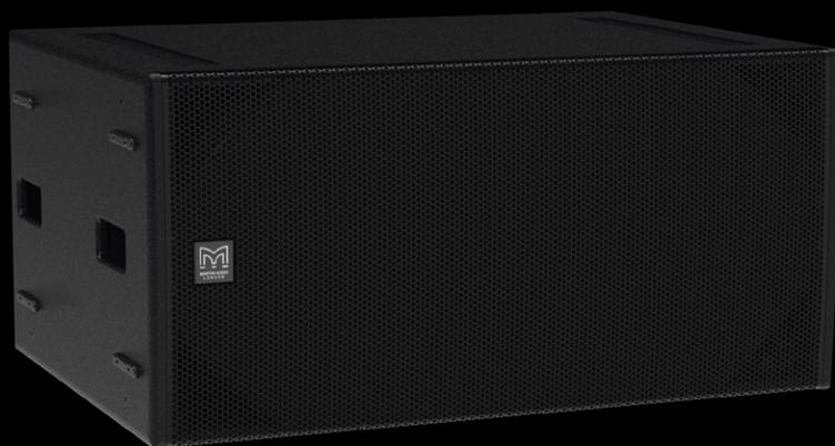
SX215はパワフルなサブウーファーで45-100Hz( + 3dB)の再生帯域を持ちます。3重構造の防水コーンを持つパワフルなロングエクスカーション15インチ(380mm)/4インチ(100mm)ボイスコイルを備えており、コンパクトなエンクロージャーから迫力ある低域を出力します。8つのリフレックスポートはその形状を調整したことで、高出力時の風切り音を抑制します。
