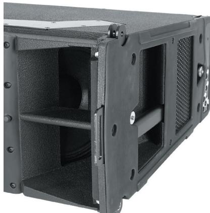
またスロットローディング方式により最適な距離に等配位された低域ドライバーは、側面方向、背面方向への回り込みを減らし、250Hz という低い帯域まで 100 度の水平指向特性を維持します。
