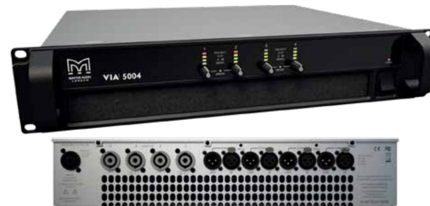
VIA5004は軽量な筐体に、ハイパワーと一流のオーディオパフォーマンスを併せ持つ、先進的な4チャンネルパワーアンプです。2Ωで1250W x4、または4Ωブリッジで2500W x2を出力することが出来るので、中小規模の設備やポータブルサウンドアプリケーションでBlacklineXやCDDを使用する際に理想的です。3chのアンプとして使用することもでき、THシリーズのような3WAYシステムを駆動する際にパーフェクトな選択肢となります。
