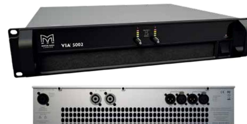
VIA5002は軽量な筐体に、ハイパワーと一流のオーディオパフォーマンスを併せ持つ、先進的な2チャンネルパワーアンプです。4Ωで2500W x2、8Ωで1500W x2を出力することが出来るので、設備やポータブルサウンドアプリケーションでサブウーファーを駆動する際に理想的です。
