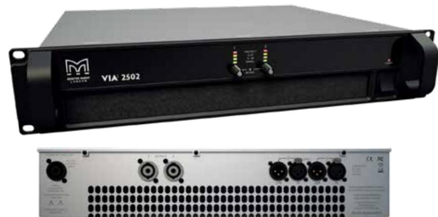
VIA2502は軽量な筐体に、ハイパワーと一流のオーディオパフォーマンスを併せ持つ、先進的な2チャンネルパワーアンプです。2Ωで1250W x2、4Ωブリッジで2500W x1を出力することが出来るので、小中規模の設備やポータブルサウンドアプリケーションでBlacklineXやCDDを使用する際に理想的です。
