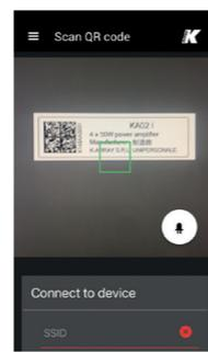
K-arrayアクティブユニットには、ローカルWi-Fi接続用のQRコードが記載されたラベルが貼られています。
