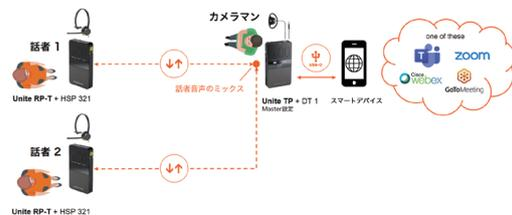
一方的な配信ではなく遠隔地とのやり取りが必要な場合、ヘッドセットマイクを装着すれば、遠隔地音声を話者が聞き、話者の音声を遠隔地に送る双方向通信も実現可能
