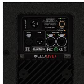
背面にはアナログ音声入力、リンク出力の他にDanteポートが2つあり、1つはシステムから接続し、もう1ポートを次のCDD-LIVE!に接続することができます。また右上のスイッチでフロアモニターモード、スタンドスピーカーモード、サブウーハーとの兼用モード、ユーザープリセットの切り替えがマニュアルで操作可能です。
