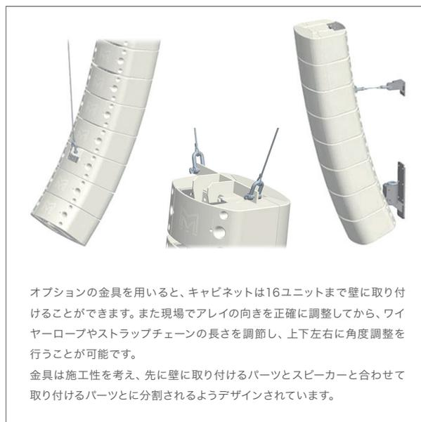
オプションの金具を用いると、キャビネットは16ユニットまで壁に取り付けることができます。また現場でアレイの向きを正確に調整してから、ワイヤーロープやストラップチェーンの長さを調節し、上下左右に角度調整を行うことが可能です。
