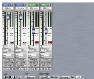
専用ソフトウェアVU-NETによりPCから全ての機能をフルコントロールすることができます。パラメトリックEQ、ミュート、ゲインその他ハイレベルなプロセッシング機能を内蔵しています。
