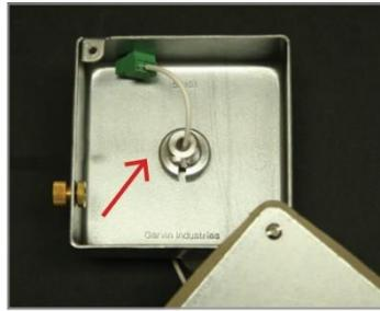
2, マイクを天井とジャンクションボックスに挿入しナットを取り付けます。
