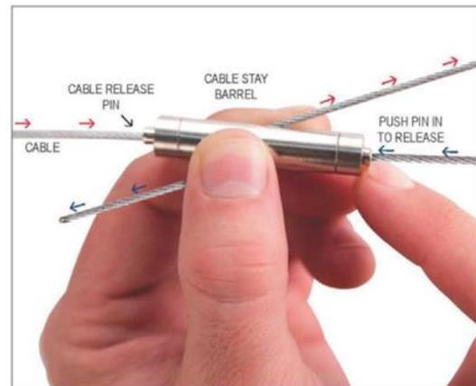
セーフティワイヤーは、アイボルトやハンガーなどに巻き付けて落下防止に使用します。ケーブルステイバレルのピンに通して、側面から出たワイヤーを引っ張ってワイヤーの長さを調節します。緩めるときは、両端にあるリリースピンを押してください。
