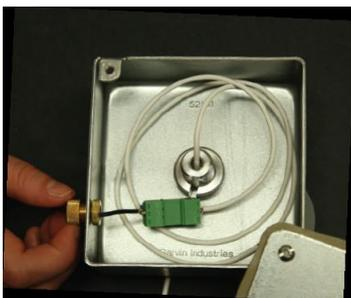
7, ケーブルクランプを締め、余分なケーブルをボックス内に巻き取り蓋をします。
